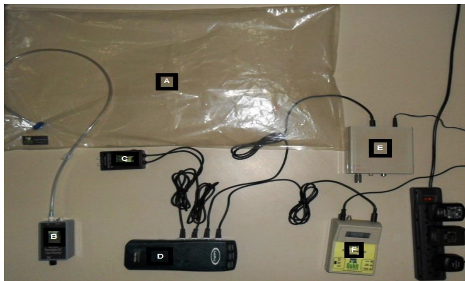
Figura 1. Acessórios do analisador de trocas gasosas. (A) Bolsa de ar; (B) Bomba de fluxo G103; (C) Sensor de Temperatura e Umidade S161; (D) Interface Lab Pro; (E) Monitor de fluxo de ar G265; (F) Analisador de gases no infravermelho IRGA S151.
